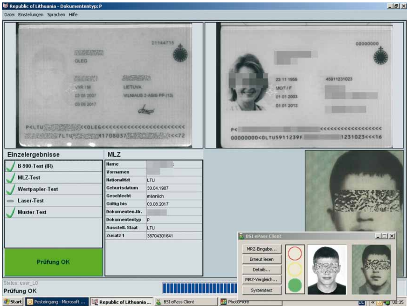
Abbildung 5: Screenshot des Visotec 300 mit der Gegenüberstellung des falschen (links) und echten litauischen Reisepasses im Infrarot-Lichtbereich.
