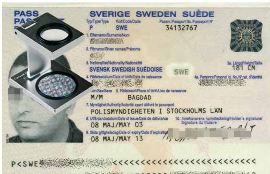
Abbildung 3: falsche Personalisierung beim schwedischen RP. Die farbigen Rasterpunkte in der Faltpulle sind bei einer original Lasergravur nicht sichtbar (siehe Abb. 4).
