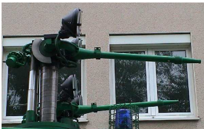
Die beiden Dachwerfer des WaWe 9000.
