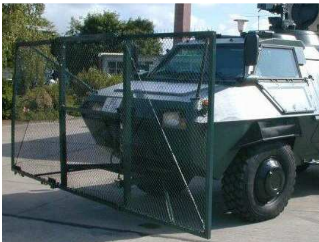
SW4 mit sogenanntem „Räumgitter“.
