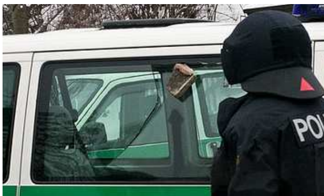
Die Lexanverglasung dieses sächsischen VW T4 ging Anfang 2010 in Dresden zu Bruch. Der verwendete Backstein hat sich verkeilt.
