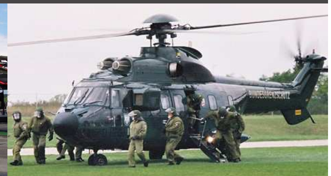
Die AS 332 der Fliegerstaffel der Bundespolizei eignen sich zum Transport von bis zu 25 Personen.
