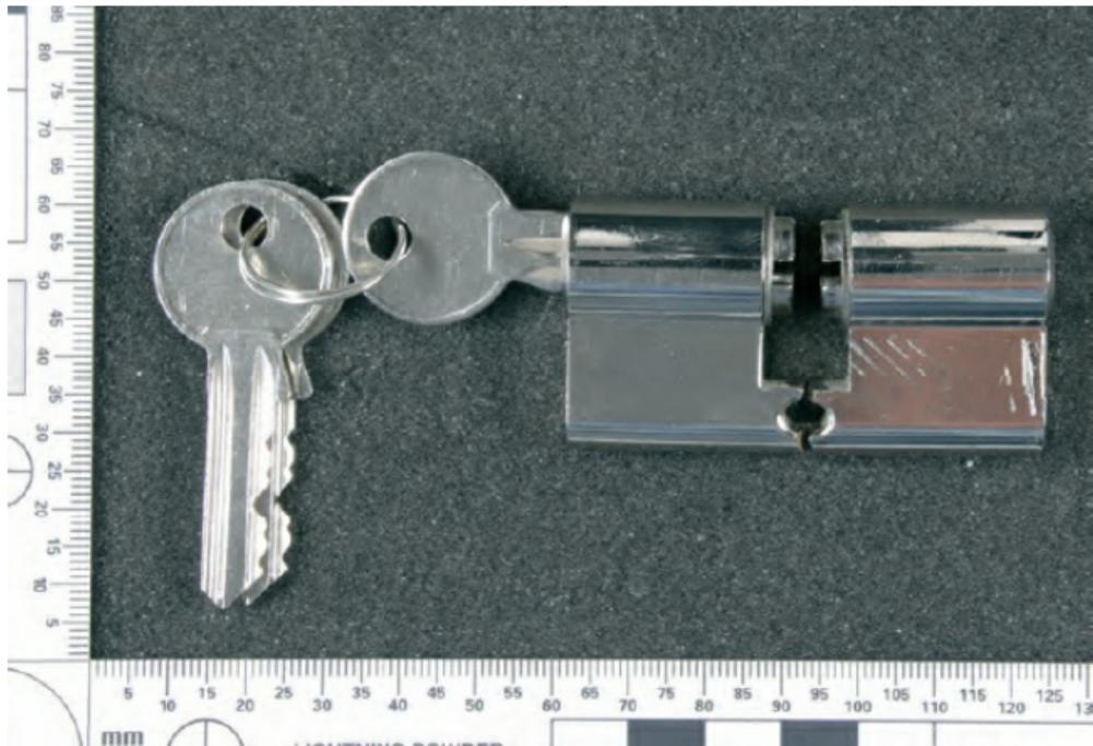
*Abb. 63: An der Stulpschraube durchgebrochener Schließzylinder*
