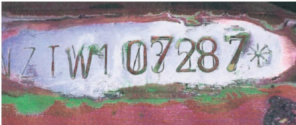
*Abb. 70: Bearbeitete FIN eines VW Polo*
