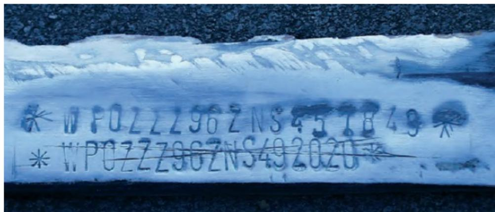
*Abb. 69: Bearbeitete FIN eines VW
