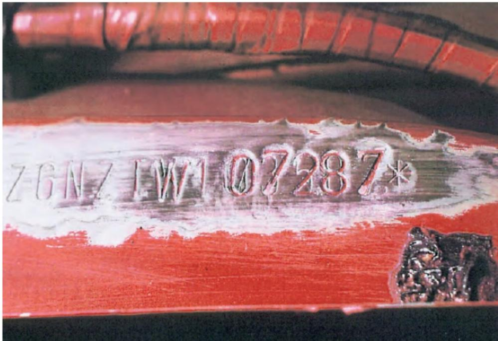
*Abb. 67: manipulierte FIN eines VW
