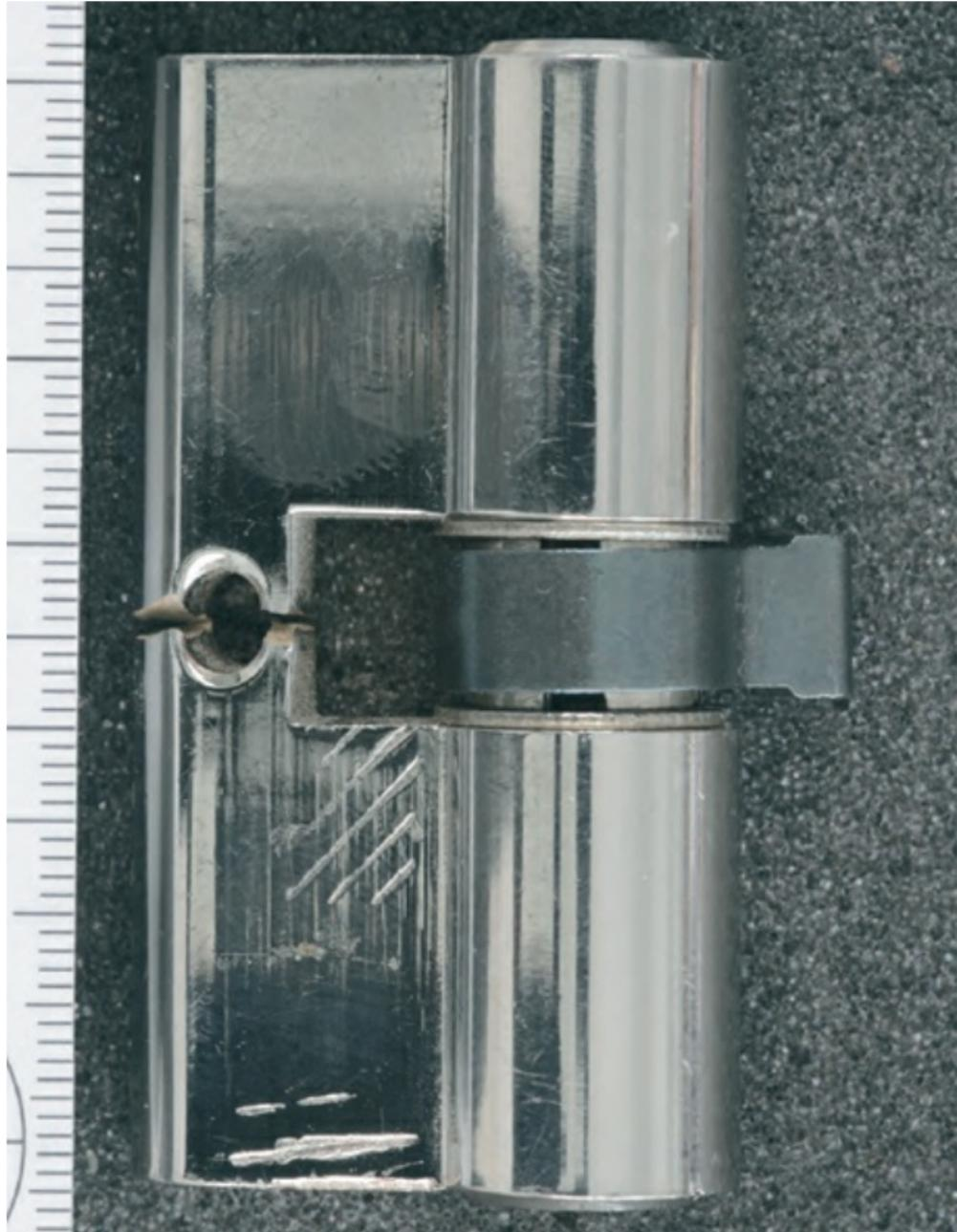
*Abb. 61: Schließzylinder mit Griffspur
