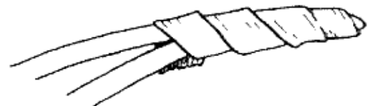
5: Isolierband so wickeln, dass es die freiliegenden Enden bedeckt. dann noch 2-3 cm weiter wickeln
