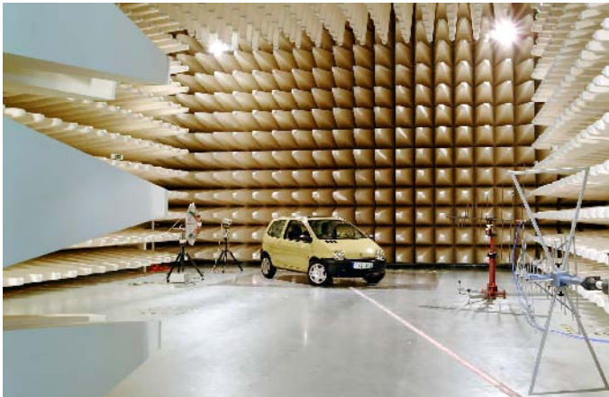
Bild 4.42 Absorberhalle der Universität Magdeburg.
