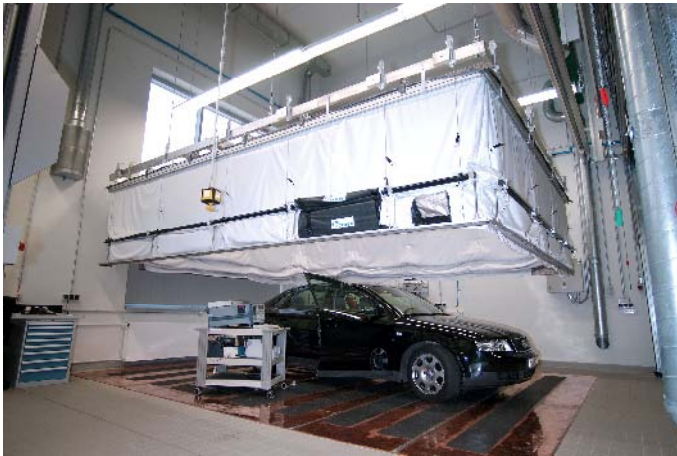
Bild 4.59 Schirmzelt für HF-Messungen an KFZ. Foto: Wrba.
