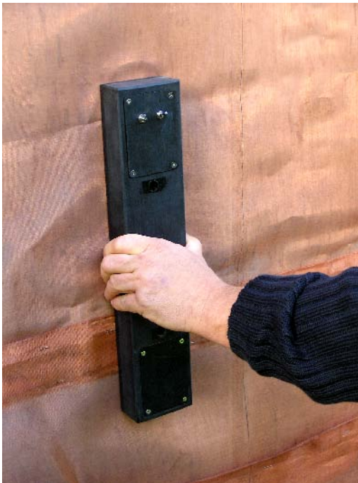
Bild 5.26 Prüfen von Materialübergängen mit Streifenleiter-Strominjektion. Streifenleiter, Injektionsadapter, Spektrumanalysator sowie eine Auswerte-Einheit zum Vergleich mit der Referenzmessung sind in einem Gerät integriert.
