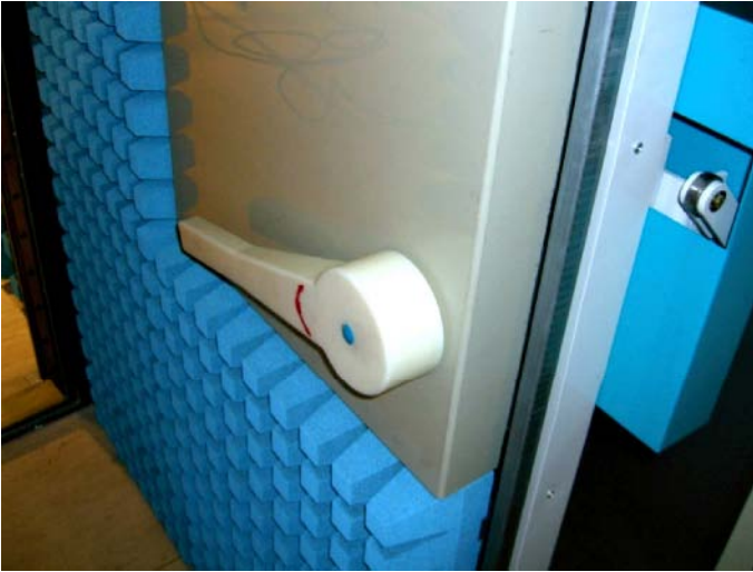
Bild 4.38 Schließmechanismus einer Absorberkabinentür. Foto: Albatross Projects.
