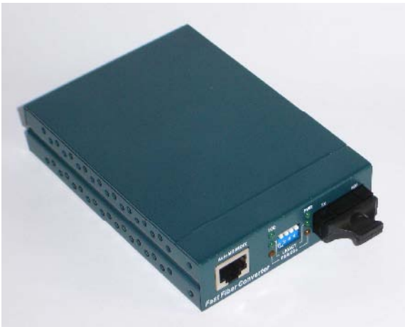
Bild 4.24 Medienkonverter 100Base TX auf 100Base FX.
